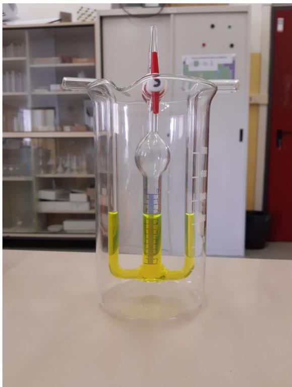
*Il liquido nell'apparecchio di Gay Lussac non arriva allo zero della graduazione. Questo accorgimento permette, una volta chiuso il rubinetto, di raffreddare l'acqua del becker con del ghiaccio, quindi l'aria diminuisce di volume e il livello del liquido si porta sullo zero. Si può naturalmente non adottare questo accorgimento, ma il numero delle misure sarà inferiore.*
