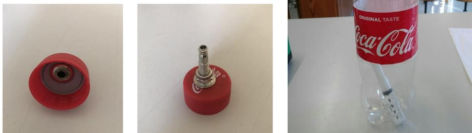
All'interno della bottiglia viene inserito un manometro a siringa autocostruito (DIY) attraverso il quale potremo misurare la pressione dell'aria all'interno della bottiglia.
