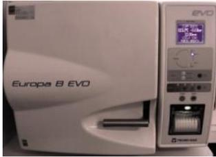
Sterilizzare con autoclave a 121°/134°. Ultimato il ciclo di sterilizzazione, scrivere su ogni strumento sigillato la data di avvenuta sterilizzazione.
